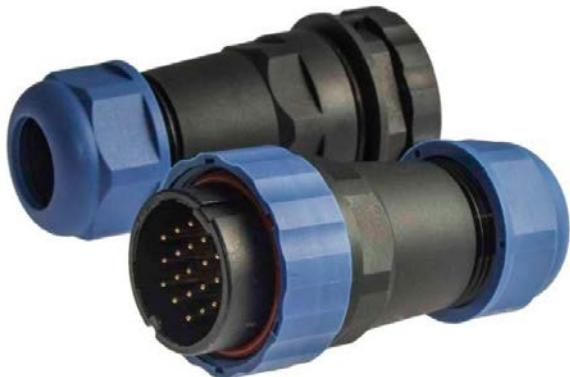
Герметичный разъем (комплект) с заглушкой SZC28 19P-F-M, вилка-розетка, 19 контактов, диаметр входящего кабеля 15 мм, IP68, 5 А, 250 В, является пылезащищенным и влагозащищенным. Герметичный разъем соответствует высокой степени защиты, что гарантирует работу разъемов при длительном погружении в воду (более 30 минут) на глубину больше 1 м.
